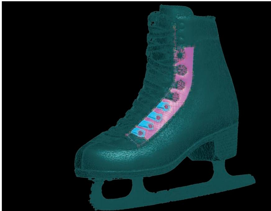
A través de la interface STL se crea en Tebis una malla poligonal. El análisis del modelo muestra que sin una preparación correspondiente en el módulo de digitalización la recuperación de superficies posterior llevaría mucho tiempo. Sería preciso reconstruir un número incalculable de superficies que también deberían alisarse, con la consiguiente pérdida de tiempo que ello supone.
